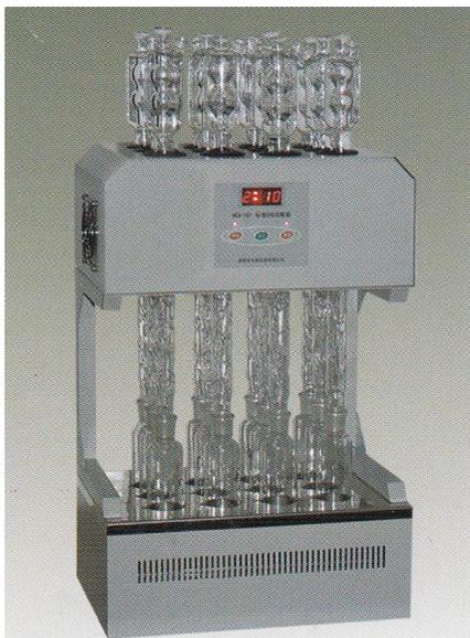
**KY-100 标准 COD 消解器**采用微电子技术进行定时控制加热电炉,可对 12 个柱型瓶毛刺回流管代替球形回流管,并以风冷技术取代自来水冷却方式,既可节水又能使仪器规范化,它们能在设定的时间内保持反应所必需的高温,以保证彻底消解。可广泛应用于环境保护、科研监测、生产监测等领域。
